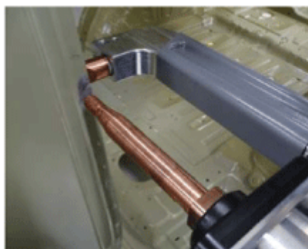
板件焊接示例 (流动电流、设定)
