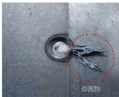
如果在板件边缘上点焊，因产生焊溅物， 使强度降低。
