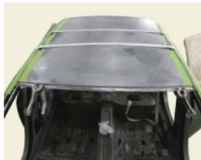
如像不能使用固定夹的车顶等部位 用绑带捆住固定
