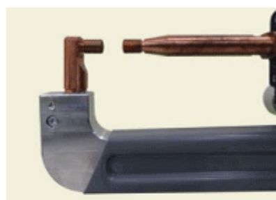
检查焊臂(尖端)的污染情况
