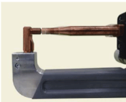
焊臂操作示例 (加压)
